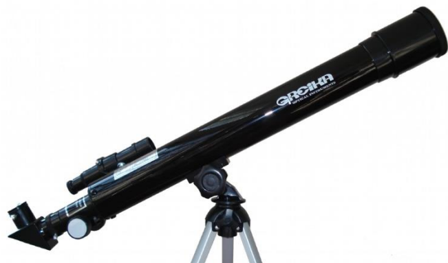
Figura 11: Imagem de um telescópio refrator, um tipo relativamente comum. Note a existência de um espelho plano abaixo da ocular: isso torna o telescópio mais ergonômico.
