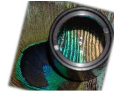
Figura 8: Imagem de uma lupa simples gerando uma imagem virtual e maior
