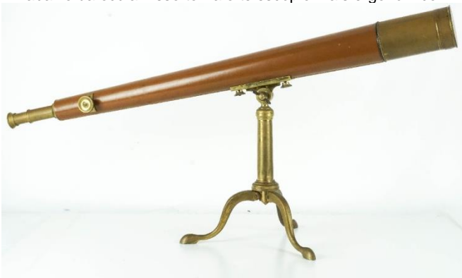
Figura 12: Luneta astronômica. Hoje em dia, os telescópios refratores podem ser utilizados como lunetas apenas substituindo a ocular. Note que a ocular não possui um espelho plano e a luneta acaba sendo menos confortável.
